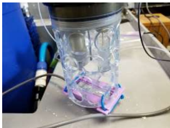
図2 ハイブリッド pH センサー（同時展示）に取り付けた現場型水中用生物付着防止装置
