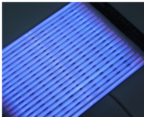
VUV 出力 300mW 消費電力 20W
