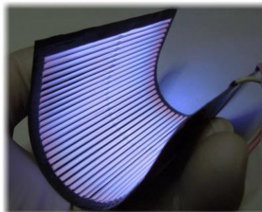
8×12cm フレキシブルな紫外線光源フィルム
