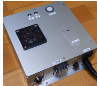
2L/分 流水殺菌装置 (不活化性能評価実験用)
