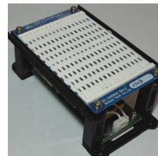
空冷ファン・回路一体型 評価用光源セット
