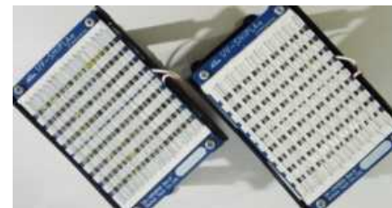
高出力型 8 x 6 cm 2 VUV面光源 (左) VUV発光 (右) VUV + 260nm発光
