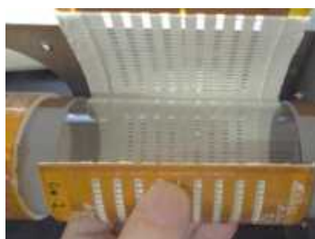
8 \times 16 \text{ cm}^2 フレキシブル面光源2枚 \phi 50 石英管に巻付けた流水リアクタ
