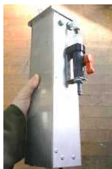
8 \times 16 \text{ cm}^2 フレキシブル面光源2枚 \phi 50 石英管に巻付けた流水リアクタ
